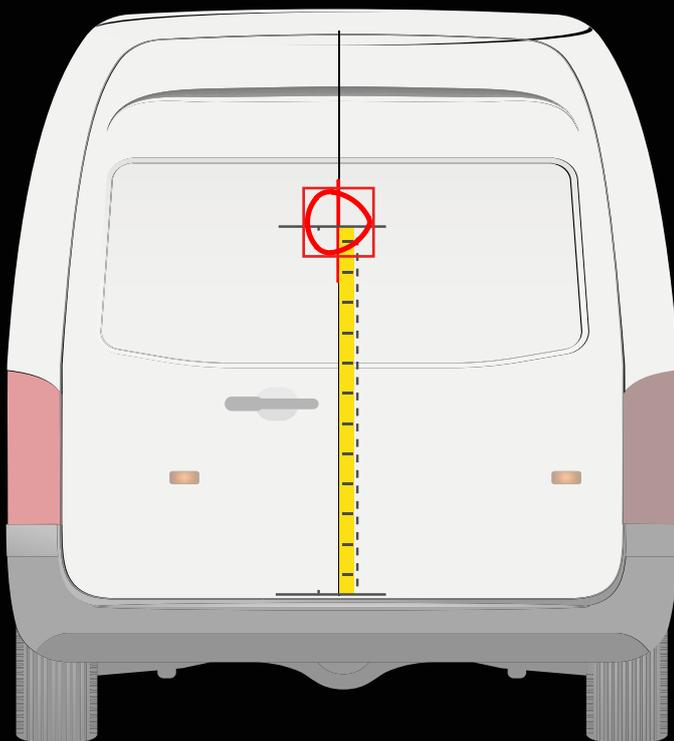
! Positionieren Sie die Bohrschablone, wie in der Abbildung gezeigt
