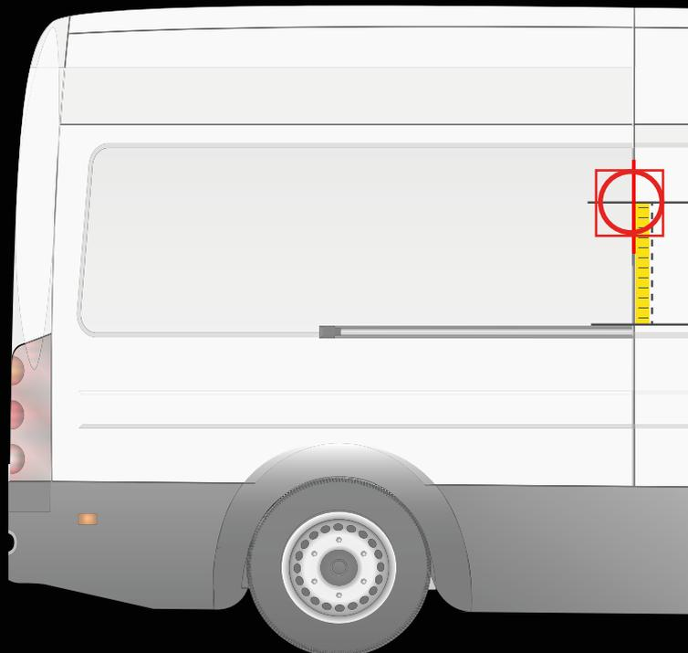
! Positionieren Sie die Bohrschablone, wie in der Abbildung gezeigt
